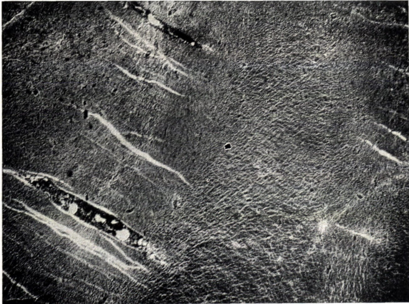
Obr. 2. Paralelné pukliny S-tvaru vzniklé pri vysychaní a kryštalizácii nontronitu z geľovitej hmoty po vylúčeníach v pyroklastickom materiáli; nikoly =, zväčš. 26×.
