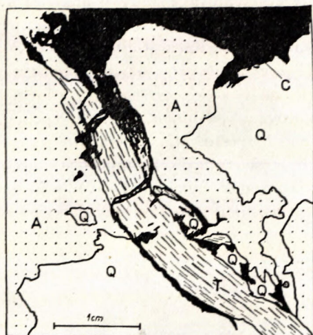
Obr. 7. Chalkopyrit (C) proniká turmalinem (T). Protože jsou zde přítomny obě generace chalkopyritu a ankerit I s ankeritem IV (označeno dohromady A), nelze z obrázku usuzovat na vzájemný poměr křemene (Q) k ankeritu. Michael József.
