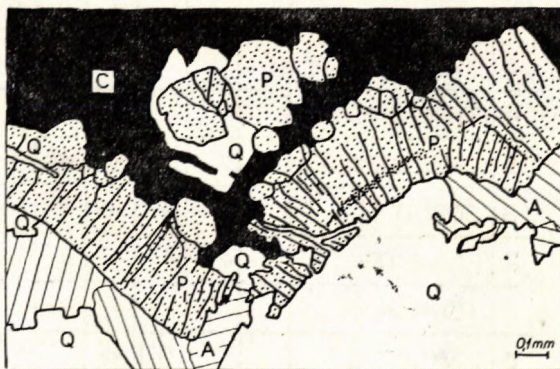
Obr. 12. Pyrit I (P) tvoří útvary vzniklé pravděpodobně růstem do dutiny (směrem do horní poloviny obrázku). V pravém agregátu je hustějším tečkováním vyznačena páska tvořená uzavřeninami neznámého charakteru, která ukazuje určitou zonárnost pyritového agregátu. A-ankerit I, Q — křemen, C — chalkopyrit.
