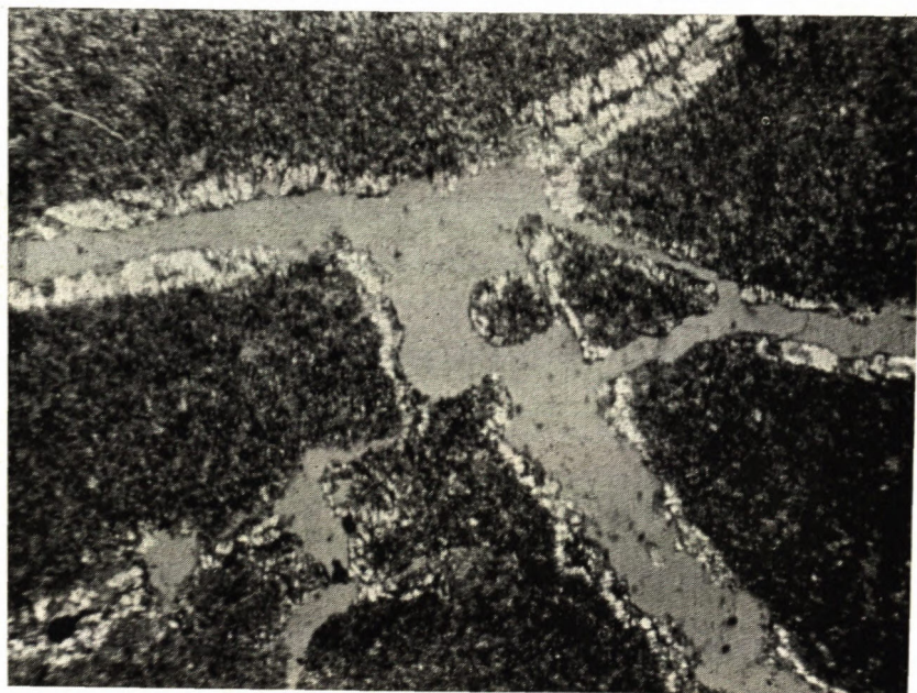
Obr. 2. Nervovite sa rozvetvujúce pukliny v nontronite s úzkou zónou chalcedónou; nikoly =, zväčš. 32×.
