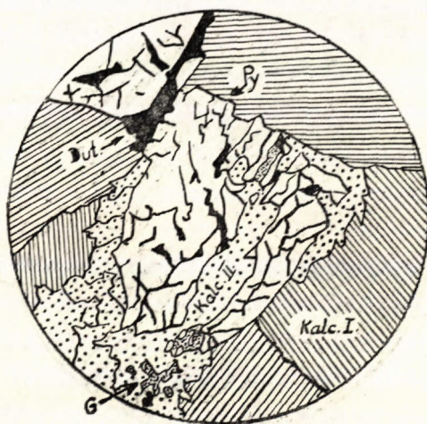
Obr. 10. Katakázovaný pyrit v kalcite I. Kalcit II metasom. zatláča kalcit I a čiastočne pyrit. Galenit pôsobí na FeS_2 i kalcit II (zv. 60×).
