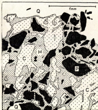
Obr. 10. Oxydy a hydroxydy železa (H) vzniklé rozkladem karbonátu (C), mají silné korozivní účinky na starší složky žiloviny. P-pyrit, Q-křemen. Halda č. 7. Vzorky rozložené žiloviny ze všech ostatních hald terénu jsou velmi podobné.
